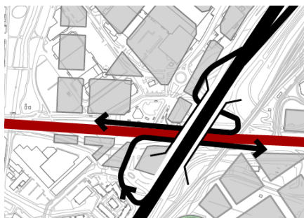
Figur 7: Skiss från förstudie Hjalmar Brantingsgatan, oktober 2024. Tänka principer för anslutning av Brantingsmotets södergående avfartsramper som minskar konflikten med kollektivtrafiken.
